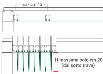
Il passo ridotto a soli 45 cm permette di avere il telo impacchettato con il minimo ingombro dal sotto trave;
