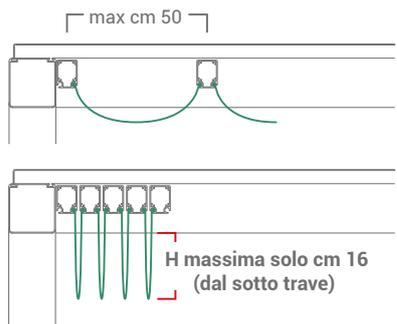
Il passo ridotto a soli 50 cm permette di avere il telo impacchettato con il minimo ingombro dal sotto trave;
